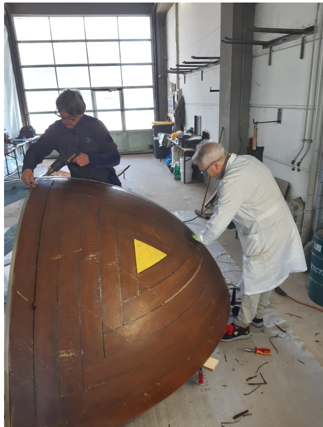
Bearbeiten der alten Holzversion zum Aufbau der Negativform
