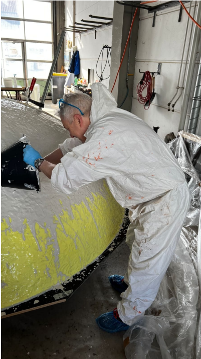
Erstellen der Negativform für die Halbkugeln aus Fiberglas
